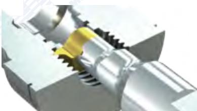
Пластины simturn DX для обработки
